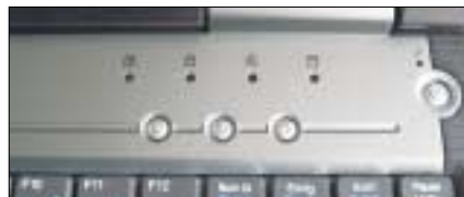
Drei Schnellstart-Tasten und vier Kontroll-LEDs befinden sich zwischen Tastatur und Display
