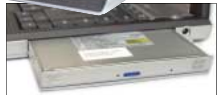
Das optische Laufwerk steckt in einem Modulschacht
