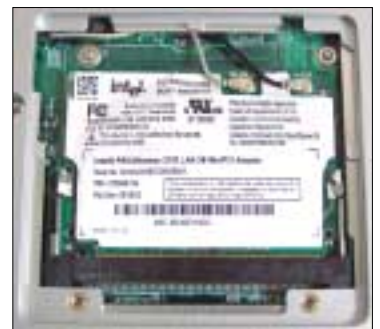
Das WLAN-Modul von Intel macht das Maxdata-Gerät zum Centrino-Notebook
